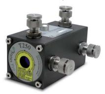
Der T250 Laser ist eine hochentwickelte Laserquelle, die bei beengten Platzverhältnissen zur Anwendung kommt. Dieser Laser zeichnet sich ebenso wie der T330 durch seine hervorragende Strahlqualität aus. Die Laserquelle ist über die vier Differentialschrauben in der Lage und im Winkel einstellbar. Die Stromversorgung erfolgt über ein Netzteil.
